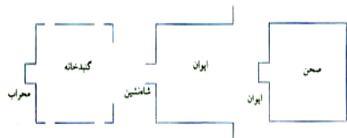
الف - نسبت ایوان به صحن ب - نسبت شاه‌نشین به ایوان ج - نسبت محراب به گنبدخانه نسبت شکلی در نظام الحاقی فضاها به یکدیگر
